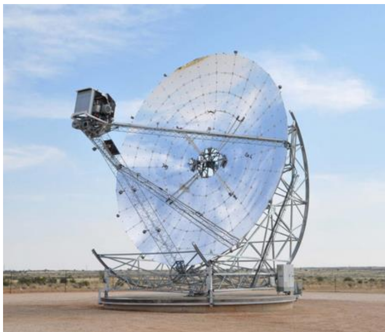
Figure 10: Ripasso Solar Dish Stirling Unit (image: Ripasso)
